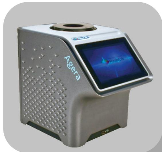
**M**it dem HunterLab **Agera** Spektralphotometer kann man die Farbe von Pulver sehr exakt messen, indem man es in eine Glasküvette füllt und diese von oben auf der Messöffnung platziert. Das Material wird durch den Boden der Küvette von unten beleuchtet und das reflektierte Licht über die Senso-
